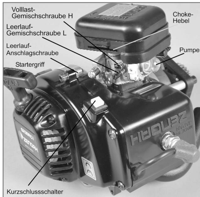
Bei den ersten zwei Tankfüllungen sollten Sie Höchst Drehzahlen im unbelasteten Zustand vermeiden ebenso wie anhaltende Vollgasfahrten auf Parkplätzen. Beim ersten Einsatz sollte auch ein Reichweitentest mit der Fernlenkanlage bei laufendem Motor durchgeführt werden.
